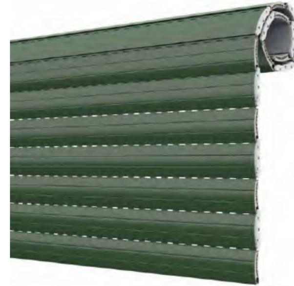
Il particolare sistema di aggancio tra le due facce della stecca interrompe la conducibilità termica del metallo, compiendo un taglio della trasmittanza termica tra l'ambiente esterno e quello interno
