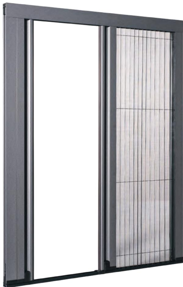
La 22 è una zanzariera con rete plissettata frizionata. A comando frizionata posizionabile in qualsiasi punto, con sistema di fissaggio a baionetta chiusura centrale con appositi ganci. La guida a terra di solo 7mm, di colore nera, rende il passaggio agevole.
