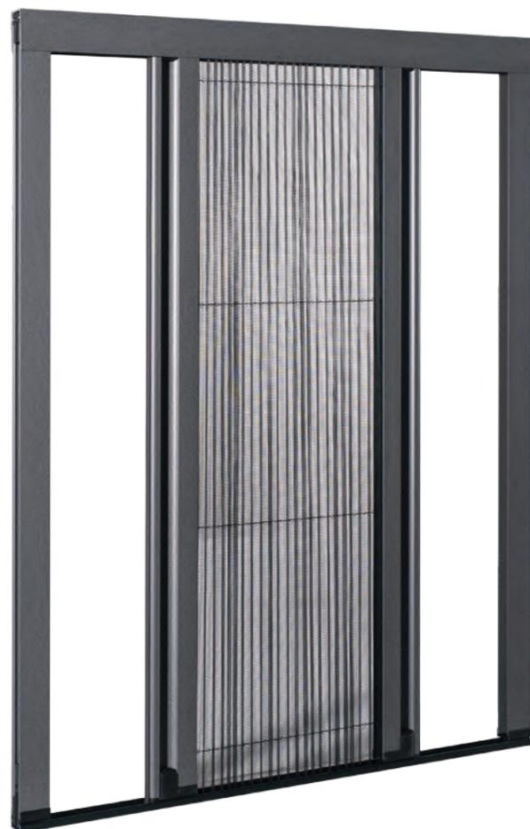
La 22 è una zanzariera con rete plissettata frizionata a comando frizionata posizionabile in qualsiasi punto, caratterizzata da due profili scorrevoli che permettono l'impacchettamento e l'estensione totale della rete da entrambi i lati, la rende molto indicata per gli infissi scorrevoli. La guida a terra di solo 7mm, di colore nero, rende il passaggio agevole.
