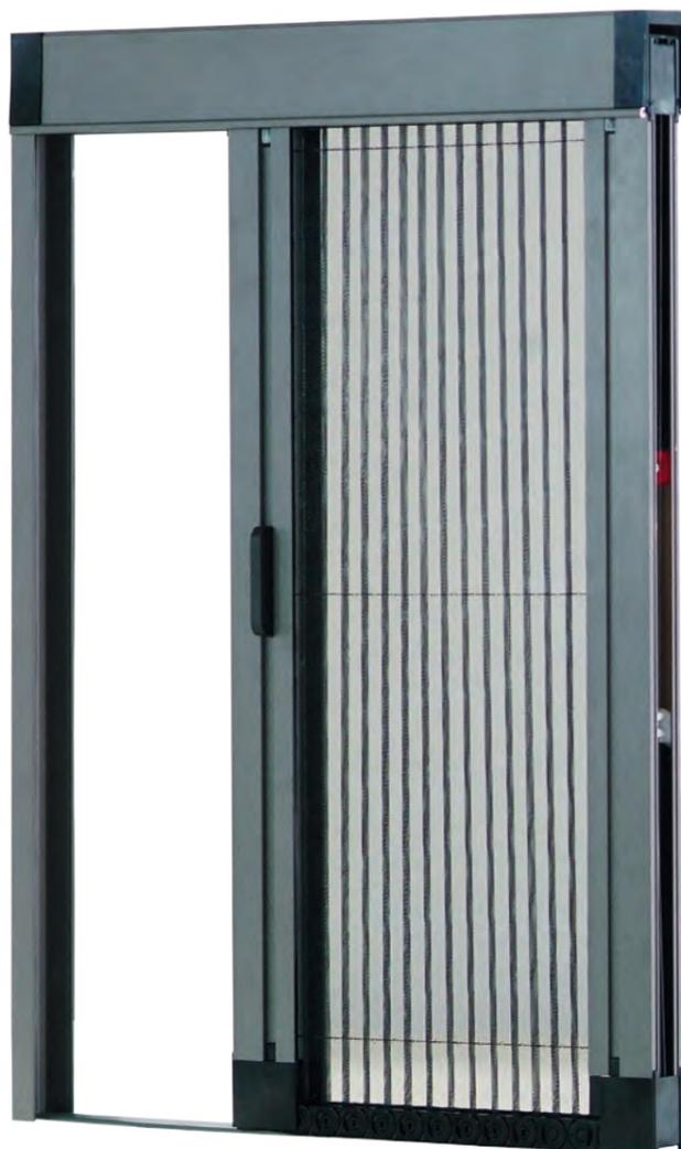
L'assenza della molla costituisce una particolarità importante nel movimento dell'anta. Posizionabile in qualsiasi punto di apertura e chiusura. Inoltre, un altro particolare molto importante è l'assenza della guida a pavimento che facilita le pulizie e il passaggio di disabili, carrelli, ecc.
