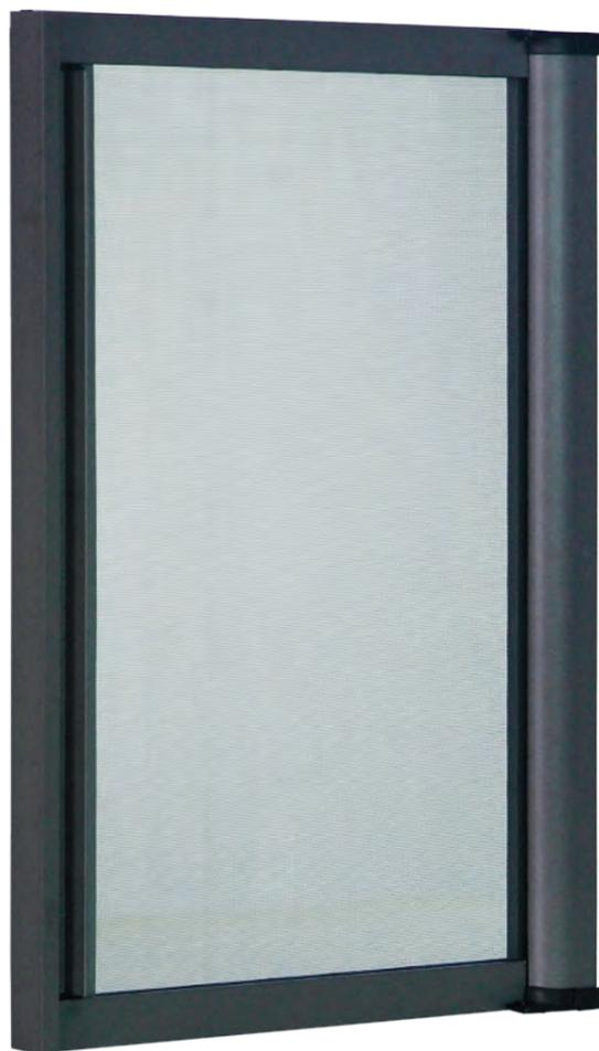
Zanzariera a scorrimento laterale con avvolgimento a molla, guida con doppio spazzolino adatta per porta/finestra, disponibile con cassonetto da 40mm. Compensazione di errore della misura solo in altezza. Facile installazione grazie ai due supporti che presentano un'apertura per il fissaggio. Chiusura magnetica o con gancio, oltre alla rete tradizionale si può richiedere l'inserimento di teli oscuranti, filtranti, zebra, rete sunox e look-out.
