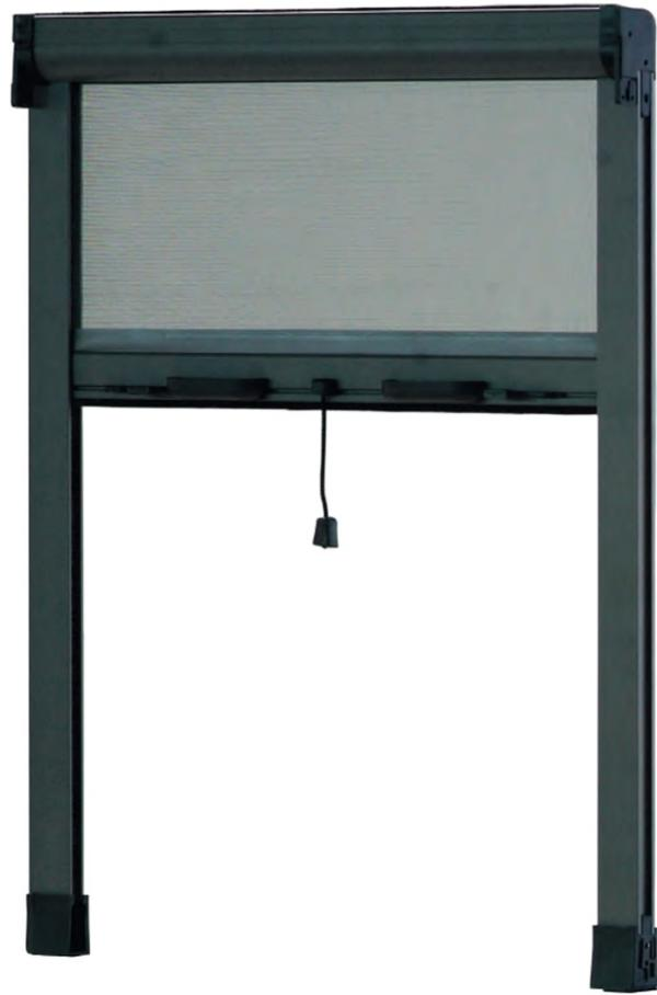
Zanzariera a scorrimento verticale con avvolgimento a molla, guida con doppio spazzolino adatta per porta/finestra, disponibile con cassonetto da 40mm. Compensazione di errore della misura solo in larghezza, oltre alla rete tradizionale si può richiedere l'inserimento di teli oscuranti, filtranti, zebra, rete sunox e look-out. Facile installazione grazie ai due supporti che presentano un'apertura per il fissaggio. Sono presenti due catenaccioli di sicurezza che bloccano le aperture accidentali.
