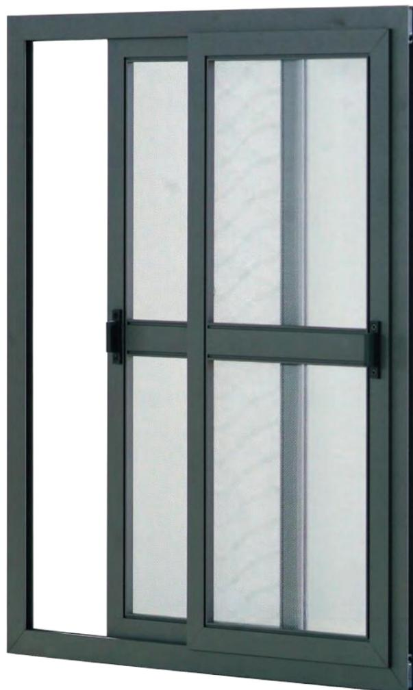
Zanzariera tradizionale adatta per finestre e porta-finestre con pannelli scorrevoli laterali è fornita su misura con rete in fibra ma può essere richiesta con rete di alluminio, pet-screen o con telo cristal. È possibile richiederla a tre o quattro ante che scorrono su due o tre binari con possibilità di usufruire a richiesta dei profili compensatori. Ingombro massimo 25mm. Altezza traverso standard 100 cm
