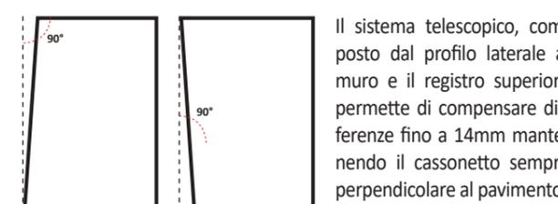
Il sistema telescopico, composto dal profilo laterale al muro e il registro superiore permette di compensare differenze fino a 14mm mantenendo il cassonetto sempre perpendicolare al pavimento.
