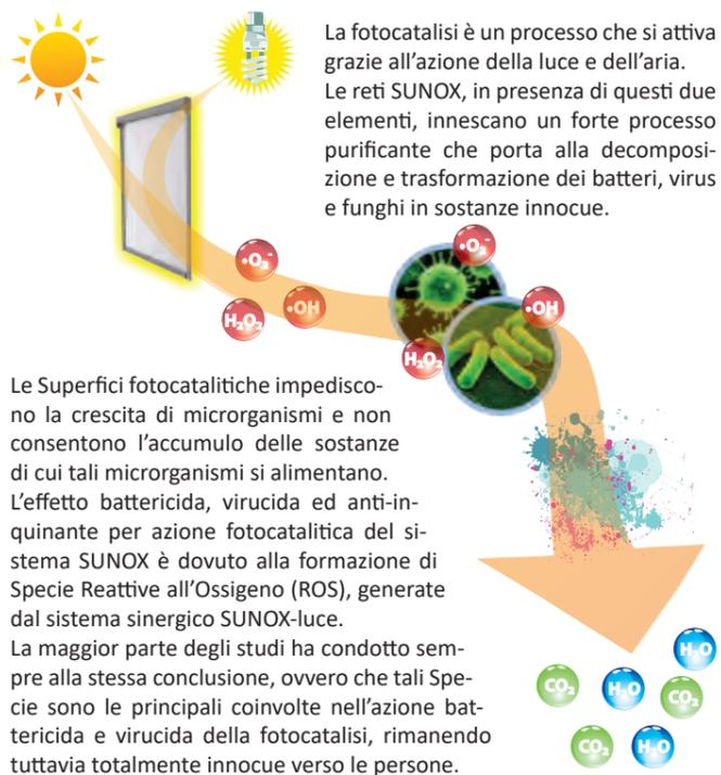
La fotocatalisi è un processo che si attiva grazie all'azione della luce e dell'aria. Le reti SUNOX, in presenza di questi due elementi, innescano un forte processo purificante che porta alla decomposizione e trasformazione dei batteri, virus e funghi in sostanze innocue.
